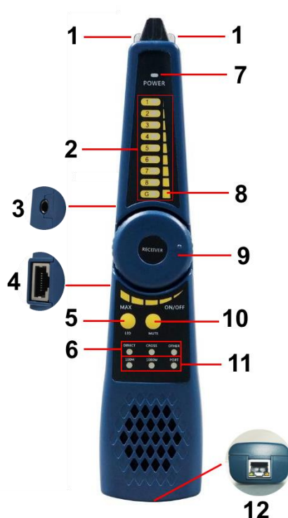
Рис. 26 Мультифункциональный щуп, разъемы и индикаторы
