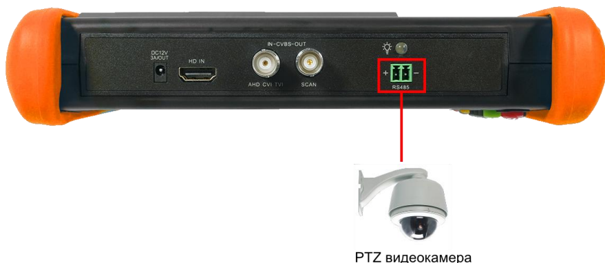
Рис.8 Подключение управляемой PTZ видеокамеры к тестеру
