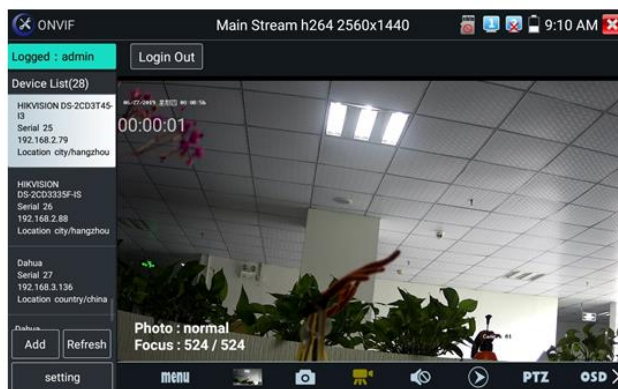
Рис. 18 Пример успешного подключения IP-видеоканеры к тестеру через Onvif
